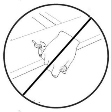
Před dotažením červíků "D" se ujistěte zda je táhlo "B" usazeno správně. Táhlo dotáhněte bez pomoci náradí do konce závitu a pootočte zpět pro umístění oka ve směru do rámu "viz předchozí obrázek". Střed oka táhla "B" musí vycházet mimo střed domečku "C". Při dotažení pak kuželový tvar červíku "D" pevně stáhne konstrukci. Níže uvádíme správné umístění oka táhla v domečku.
