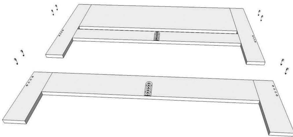
Před dotažením červíků "D" se ujistěte zda je táhlo "B" usazeno správně. Táhlo dotáhněte bez pomocí náradí do konce závitu a pootočte zpět pro umístění očka ve směru do rámu "viz předchozí obrázek". Střed očka táhla "B" musí vycházet mimo střed domečku "C". Při dotažení pak kuželový tvar červíku "D" pevně stáhne konstrukci. Níže uvádíme správné umístění očka táhla v domečku.
